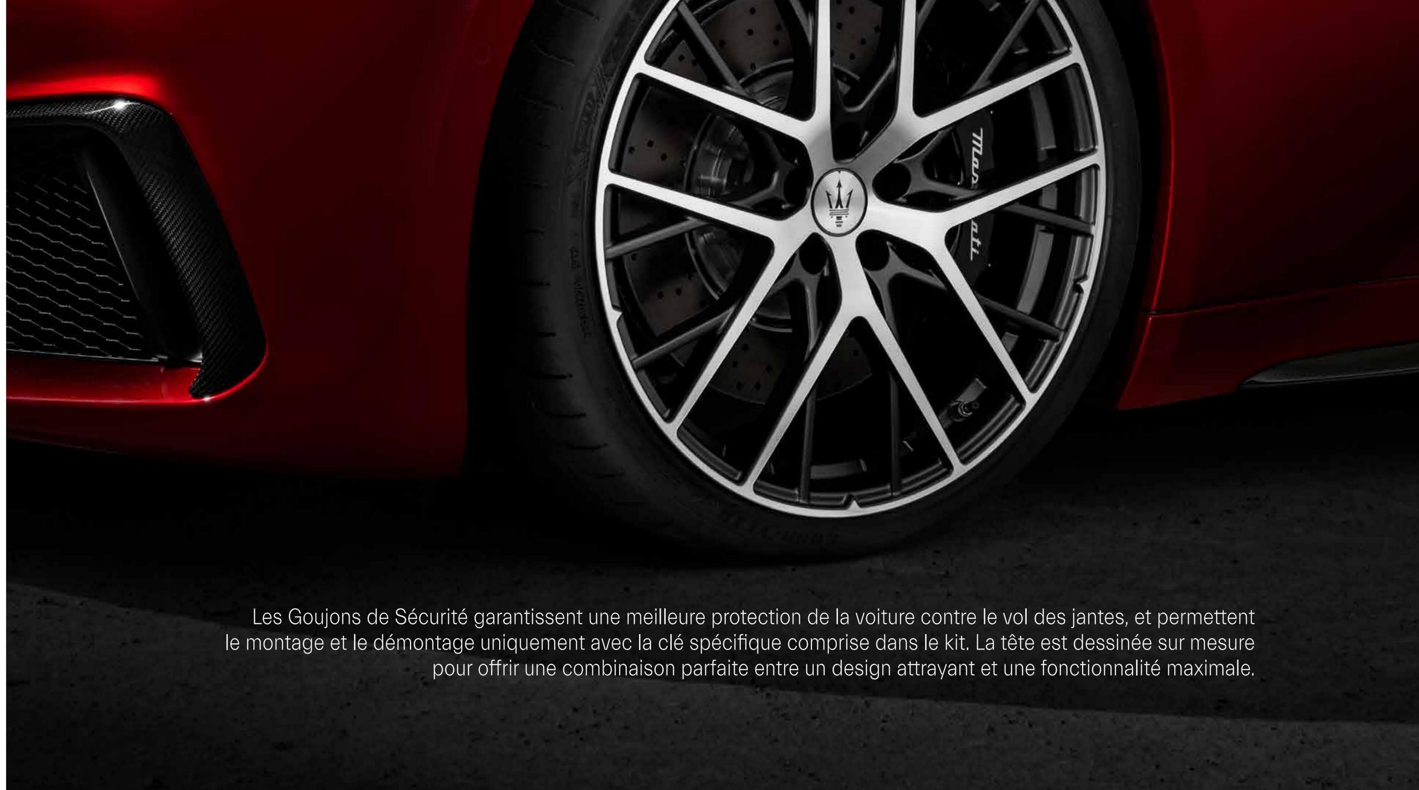
Les Goujons de Sécurité garantissent une meilleure protection de la voiture contre le vol des jantes, et permettent le montage et le démontage uniquement avec la clé spécifique comprise dans le kit. La tête est dessinée sur mesure pour offrir une combinaison parfaite entre un design attrayant et une fonctionnalité maximale.
