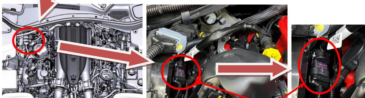
燃料圧力・温度センサー
